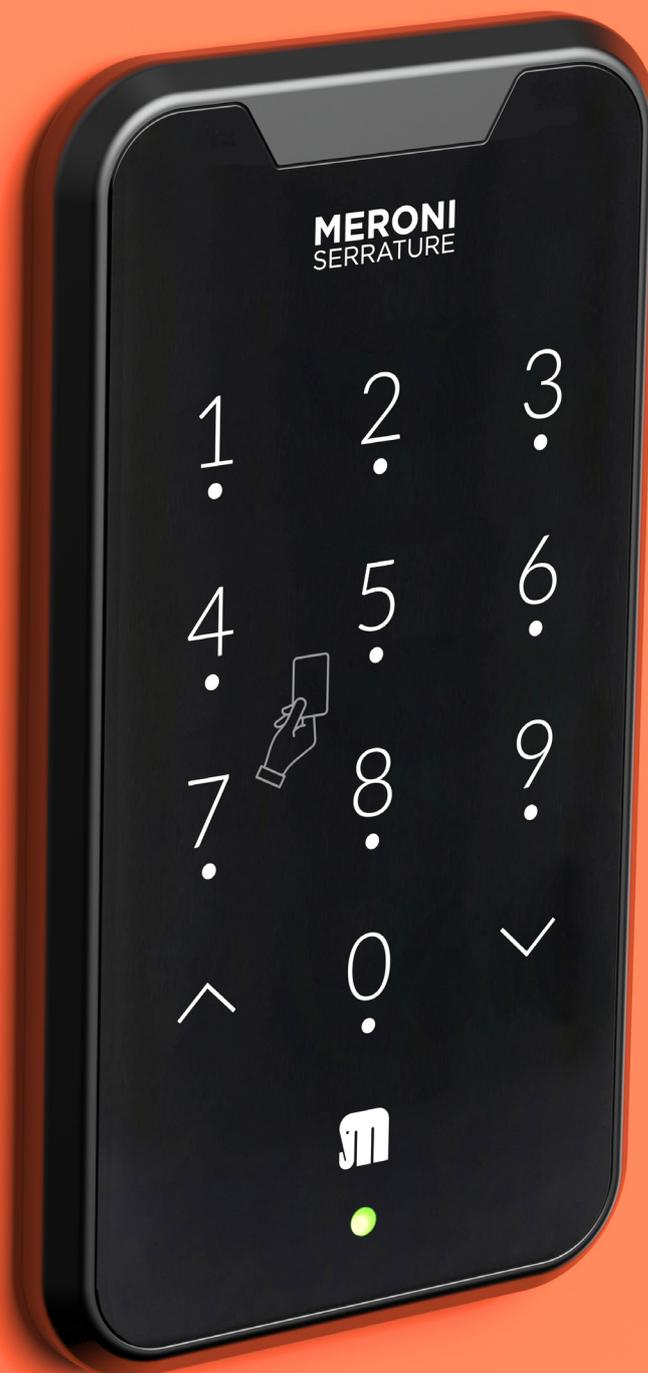
WPAD rfid è la serratura elettronica con tastiera frontale, wireless e alimentata a batteria adatta all'applicazione sulle ante degli armadietti. Può essere utilizzata come una serratura a combinazione (codice da 4 a 15 cifre), oppure come lettore avvicinando una tessera RFID o con uno smartphone grazie all'NFC (in modalità pubblica).
