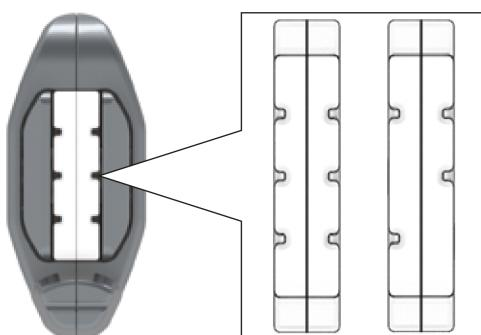
Il NUOVO Defender® MAGNETICO DF371 (Brevettato) regolabile a molla, è composto da un Defender® d'acciaio con mostrina in lamiera (72 x 90 mm) e da una speciale copertura rotante che protegge completamente l'entrata chiave. La rotazione del corpo rotante è comandata dalla speciale chiave magnetica, la cui sicurezza è data dalla combinazione delle polarità dei 5 magneti e 8 posizioni possibili.
