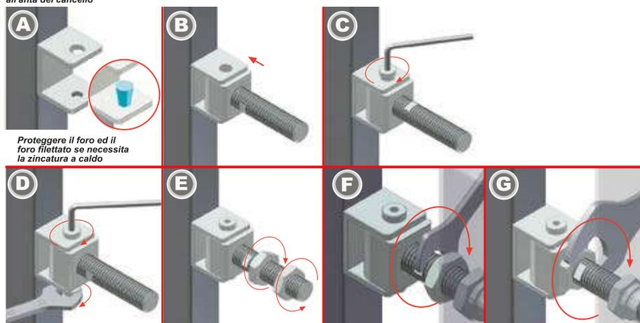
Proteggere il foro ed il foro filettato se necessita la zincatura a caldo
