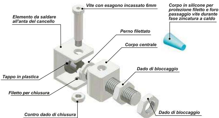
Corpo in silicone per protezione filetto e foro passaggio vite durante fase zincatura a caldo
